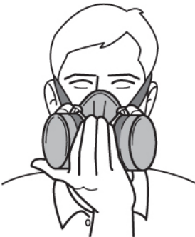
Figure 4 : Vérification de l'étanchéité à la surpression
